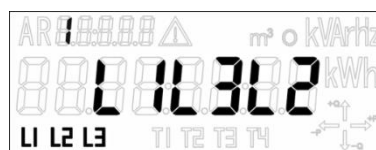
Figur 37: Feil rekkefølge på faser.
